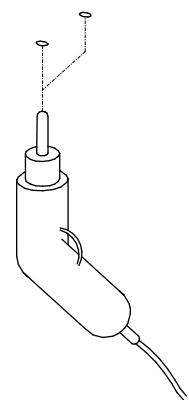
Löcher der Markierung entsprechend bohren und Dübel einsetzen (siehe hierzu: "Befestigungshinweise").
