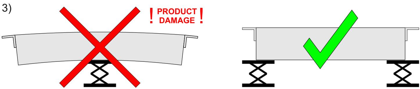
Die Projektionswand darf im Mittelteil nicht abgestützt werden !
