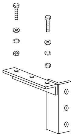
**Montageset für abgehängte Decken** (muss extra bestellt werden)
